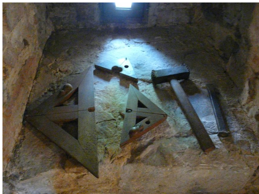
Steinmetz-Werkzeug: dreieckige Maßbretter (Foto: Piotrus CC BY-SA 3.0)
